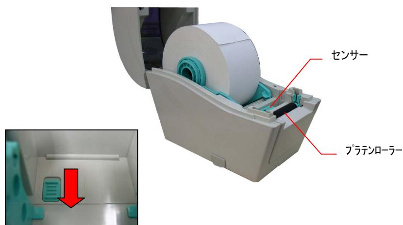
4. 下図のようにラベルの印字面を上にして、メディアガイドの下を通して、ラベルロールの先端を引き出します。
