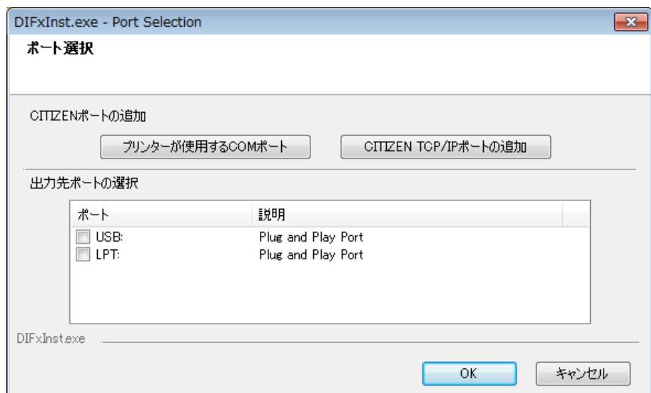
・ステータスマニター付ドライバーで CITIZEN TCP/IP ポートを使用せず、Standard TCP/IP ポートを使用すると、固まってしまう現象が発生する事があります。必ず CITIZEN TCP/IP ポートをご使用下さい。
